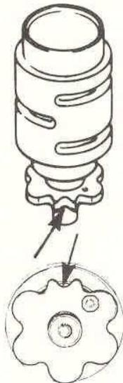
Avant de remonter les moitiés du carter, régler le mécanisme de changement de vitesse et s'assurer que le sélecteur s'appuie contre la rainure du point mort.
