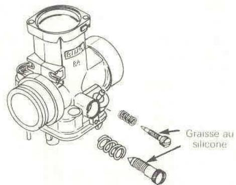
Appliquer une couche de **graisse** au silicone (DC-4 ou l'équivalent) au couvercle du carburateur, et à l'enveloppe de caoutchouc du câble d'accélérateur (au haut du carburateur).
