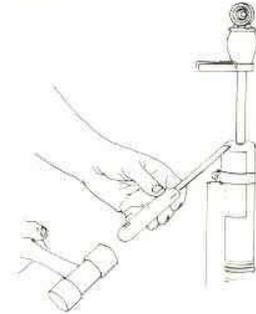
⑧ Nettoyer la partie située au-dessus du roulement de laiton, puis, à l'aide du support d'amortisseur, enfoncer le roulement de laiton d'environ 6.0 mm (1/4") (ou jusqu'à ce qu'il soit arrêté).
