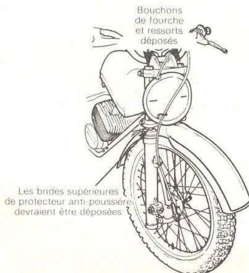
Pour régler, desserrer les vis de blocage des couronnes supérieure et inférieure, puis resserrer à:
