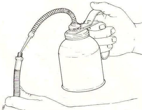
Tenir le boyau à la verticale contre le corps d'amortisseur et laisser s'échapper les bulles d'air.
