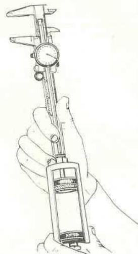
Au besoin effectuer les corrections nécessaires afin d'obtenir la distance appropriée en enlevant la tige de soupape et en poussant doucement avec le tournevis à lame émoussée. Si le piston est enfoncé trop profondément, pousser de l'autre côté.
